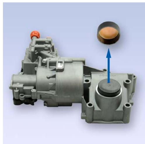
Снятие уплотнительного колпачка
