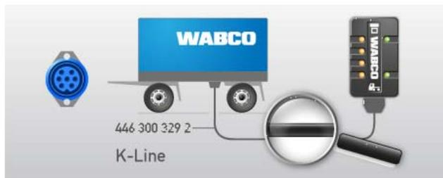
Vor dem Start des Fahrzeugscans wählt der Nutzer lediglich den Diagnoseanschluss des Fahrzeuges und das dazu passende Diagnosekabel.
