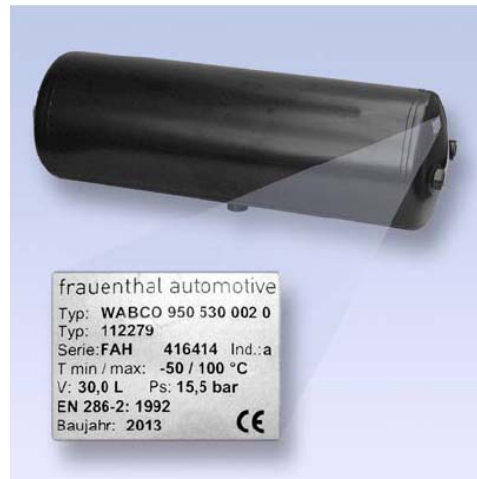
Vzduchojemy WABCO s novým typovým štítkem
