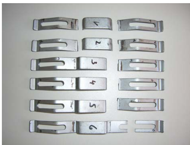
Fig. 2 : Les ressorts de l'autre fabricant sont rompus
