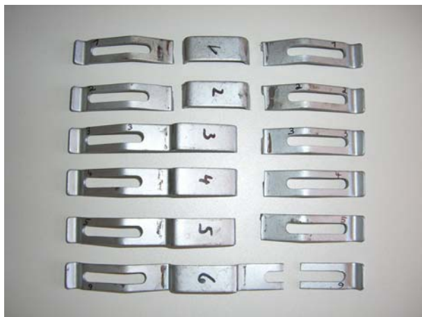
Fig. 2: Los muelles de sujeción rotos del proveedor ajeno
