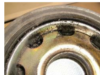
Abbildung 2: mit Koaleszenz Filter: Air System Protector nach 60.000 km
