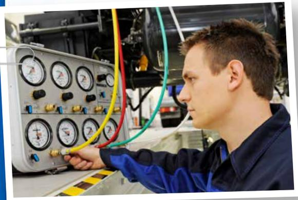
“ 在修理车辆上发生了故障的制动系统时，常常很难确定制动系统中到底哪个部件出了毛病。这一查找工作常常需要花费很长时间，从而导致车辆长时间无法运行。有了移动式试验台，这个难题便迎刃而解了：我们现在能够直接进行一次彻底的详细检测，从而避免了不必要的修理时间。 ”
