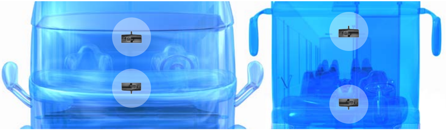
Mögliche Kamera-Montagepositionen – oben oder unten an der Windschutzscheibe mit 180° Panorama-Rotation
