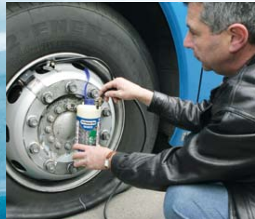
השתמש במדחס של מערכת האוויר של המשאית כדי להזרים את חומר האטימה דרך חולץ השסתום, המונע גם דליפה חוזרת של החומר לאטמוספירה.
