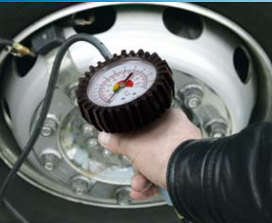
השתמש במד הלחץ של ערכת המילוי ובצינור באורך 10 מטר כדי לבדוק מדי פעם את לחץ הניפוח של הצמיג.
