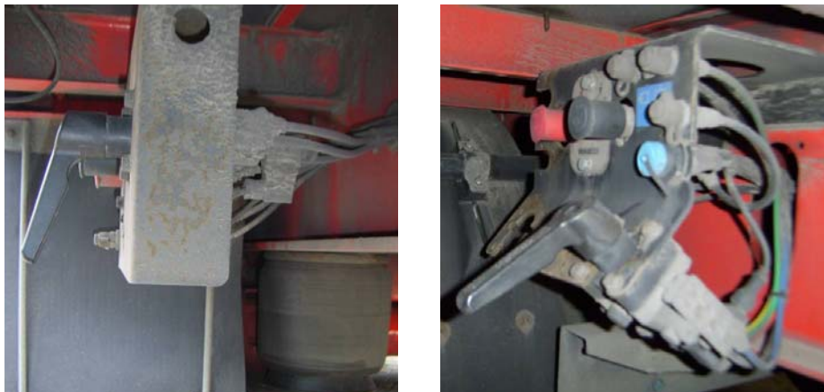
fig. Válvula giratoria con función RtR de otra marca con conector plano (izquierda) y bayoneta DIN (derecha)
