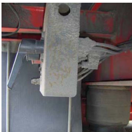
fig. Robinet rotatif à fonction RtR d'un autre fabricant, à fiche plate (gauche) et à baïonnette DIN (droite)
