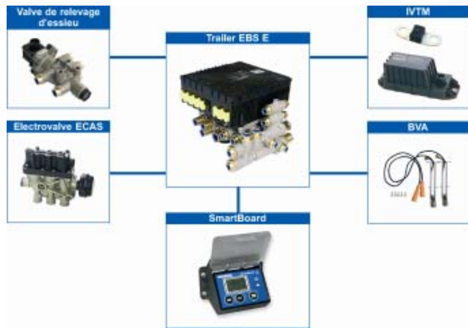
fig. 3-2: Configuration système en corrélation avec EBS E Remorque
