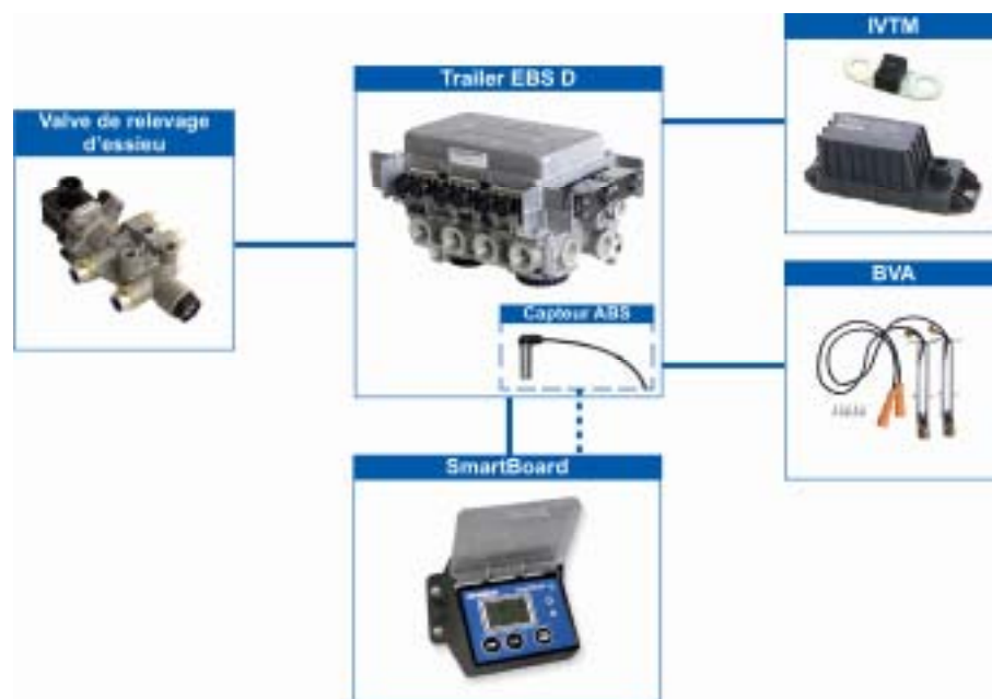
fig. 3-1: Configuration système en corrélation avec EBS D Remorque
