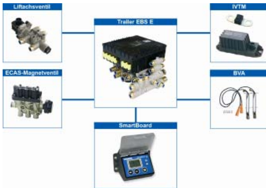
Abb. 3-2: Systemkonfiguration in Verbindung mit Trailer EBS E
