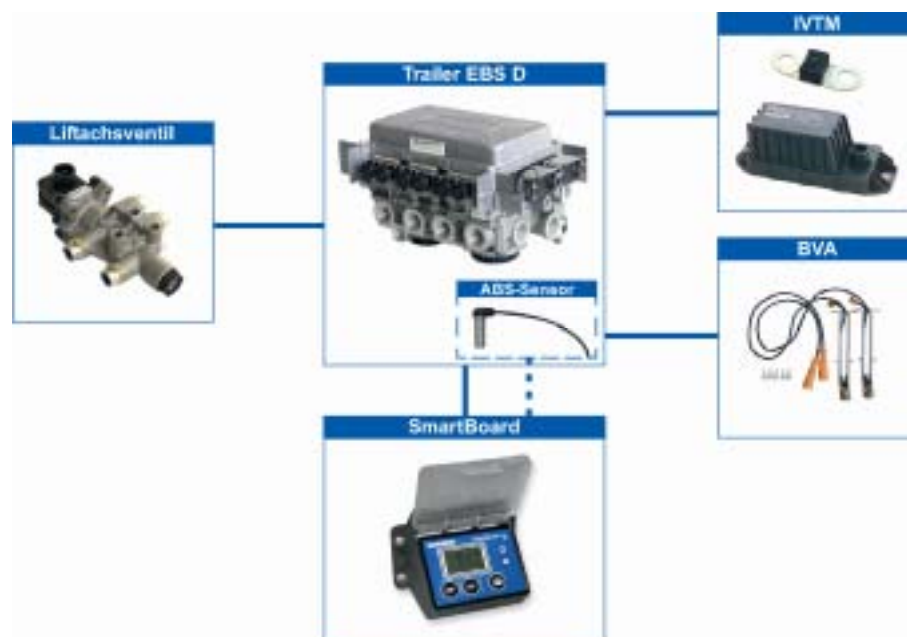
Abb. 3-1: Systemkonfiguration in Verbindung mit Trailer EBS D
