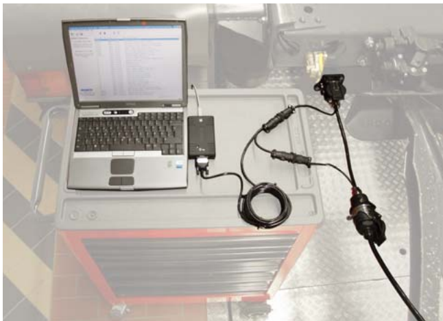
Billede 3 Kabelforbindelse via ISO 7638
