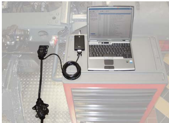
Billede 4 Kabelforbindelse via ISO 12098
