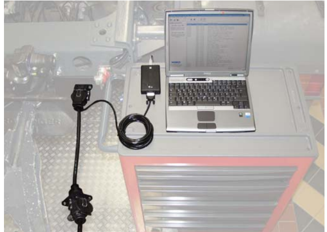
Bild. 4 Kabelanslutning via ISO 12098
