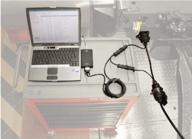
Bild. 3 Kabelanslutning via ISO 7638
