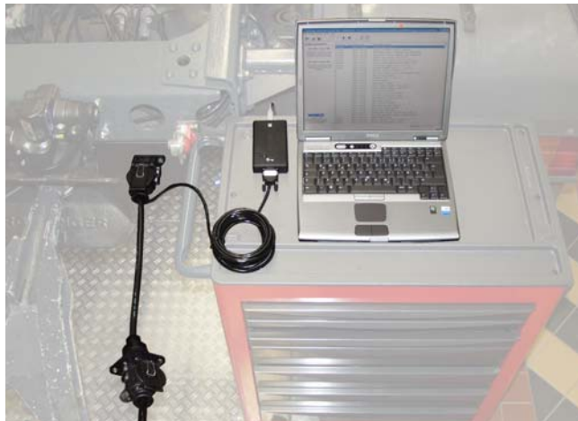
Fig. 4 Connessione dei cavi attraverso ISO 12098
