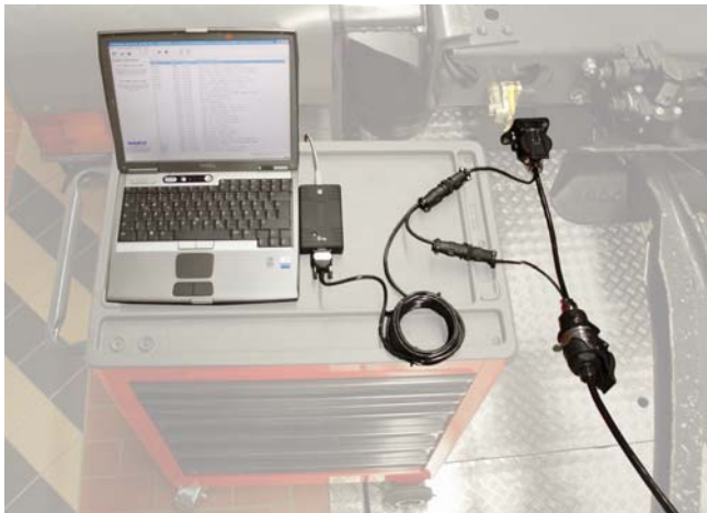
Fig. 3 Connessione dei cavi attraverso ISO 7638
