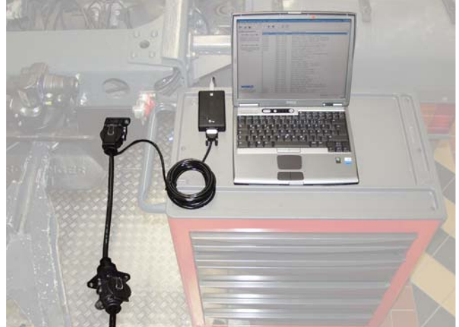
Fig. 4 Conexión de cables mediante ISO 12098
