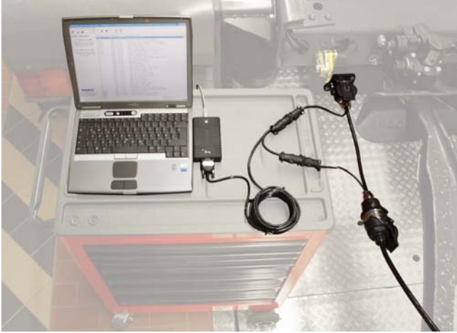
Fig. 3 Conexión de cables mediante ISO 7638
