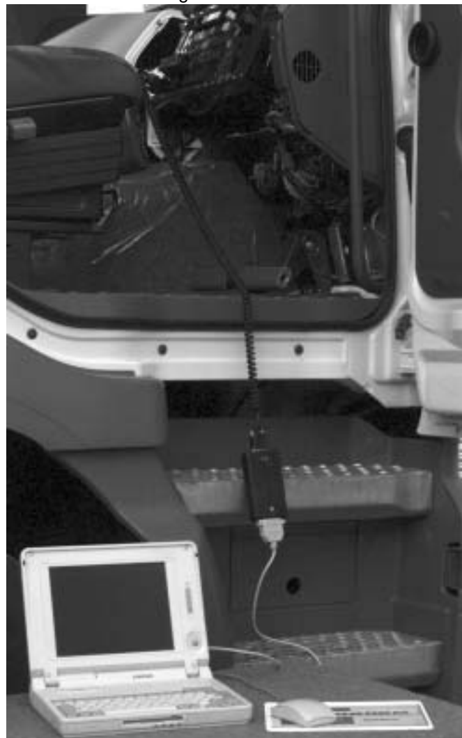
Fig. 2: collegamento del computer portatile al collegamento di diagnosi dell'Actros
