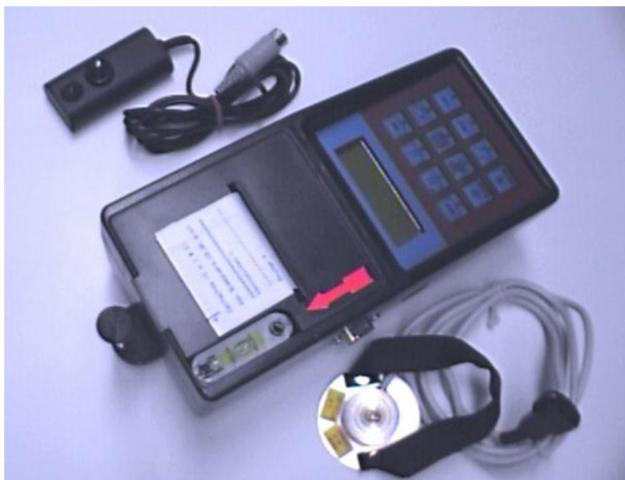
Bild: MAHA-Verzögerungsmeßgerät VZM 100 mit Pedalkraftmesser und Handauslöser
