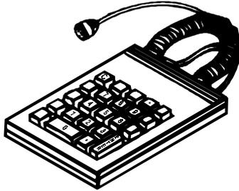
Die externe Tastatur ist zur Änderung der Parameter zwecks einfacher Bedienung zu empfehlen. Diese sind jedoch nur für besonders autorisiertes Personal über eine spezielle Programmkarte zugänglich. Die hier nicht gekennzeichneten Tasten sind nicht belegt und daher ohne Funktion.
