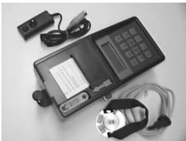
Misuratore di ritardo MAHA VZM 100 con misuratore di forza sul pedale e dispositivo d'azionamento manuale
