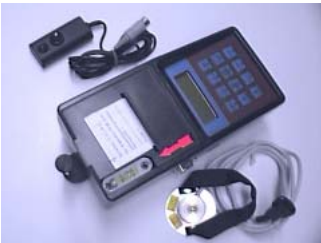
MAHA-Verzögerungsmeßgerät VZM 100 mit Pedalkraftmesser und Handauslöser
