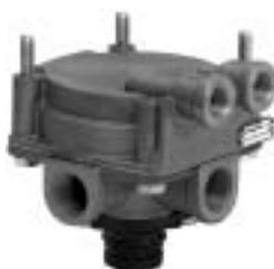
e. **Relaisventil** mit Überlastschutz. Neuentwicklung für Federspeicherbremse, **mit integrierter Druckreduzierung** von Anschluss **(42)** zu **(2)**. Ersetzt 473 017.
