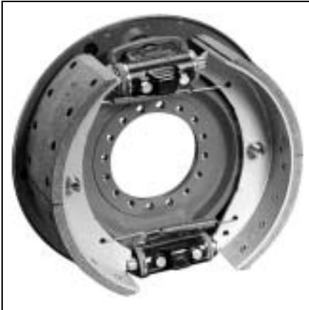
Freno a tamburo con cuneo ad espansione Duplex 410 × 180 DE
