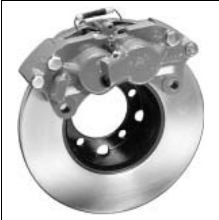
Essieu avant : frein à disque hydraulique 4 pistons à étrier fixe
