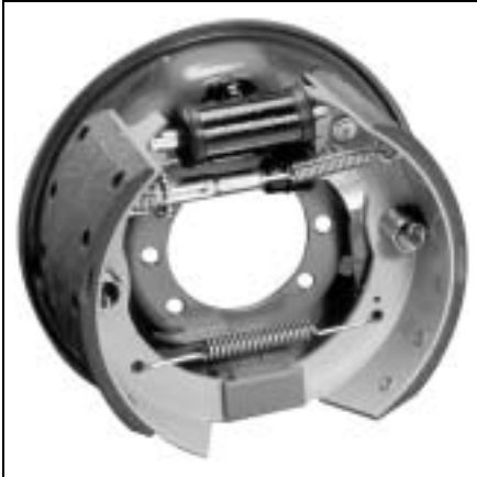
Essieu arrière : frein à tambour hydraulique simplex avec commande mécanique 325 × 150 Z-Öm
