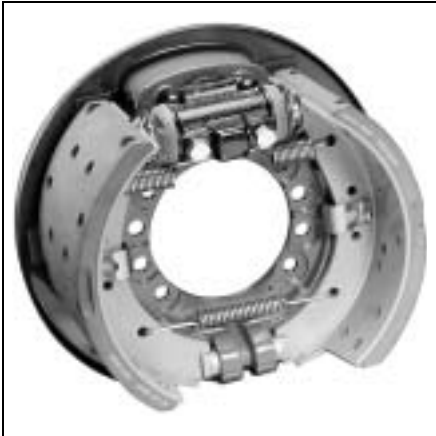
Vorder- und Hinterachse: Spreizkeil-Simplextrommelbremse 410 × 200 ZE
