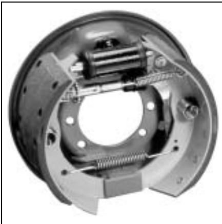
Hinterachse: Hydraulische Simplextrommelbremse mit mech. Zusatzbetätigung 325 × 150 Z-Öm
