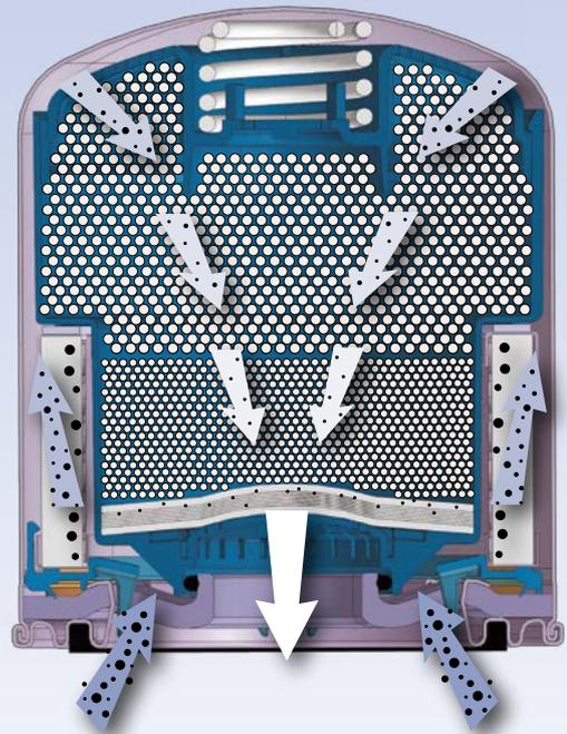
Mit dem Air System Protector<sup>PLUS</sup> bieten wir ein Produkt an, dessen Leistung bei der Abscheidung von Öl und Aerosolen die Fähigkeiten aller anderen heute verfügbaren Kartuschen übertrifft.
