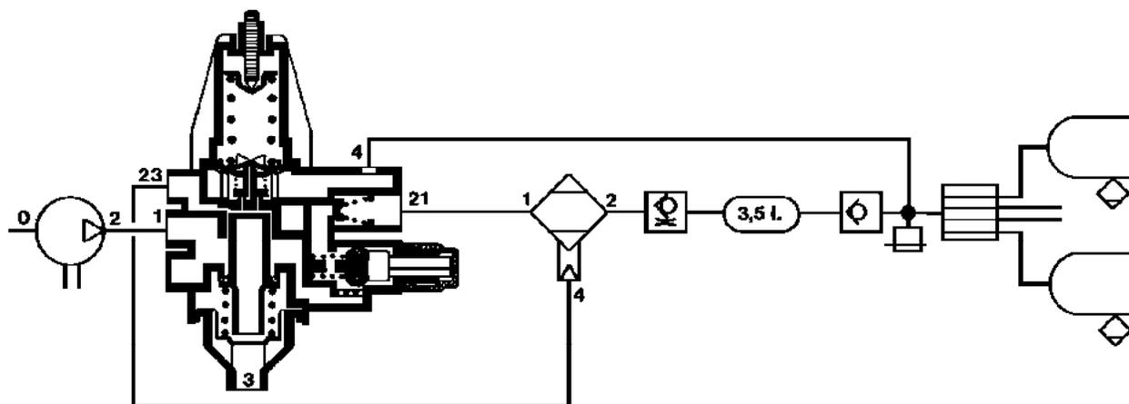
Régulation de pression avec dessiccateur d'air à 2 chambres
