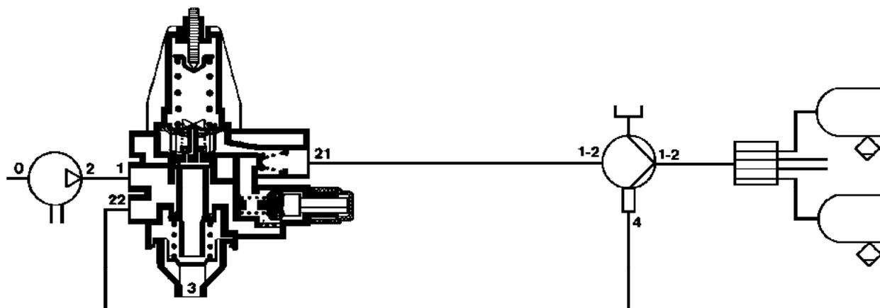
Régulation de pression avec dessiccateur d'air à 1 chambre
