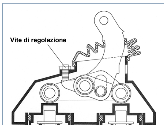
Fig. 4 Valvola freno 461 499 - Sezione trasversale, posizione della vite di registrazione
